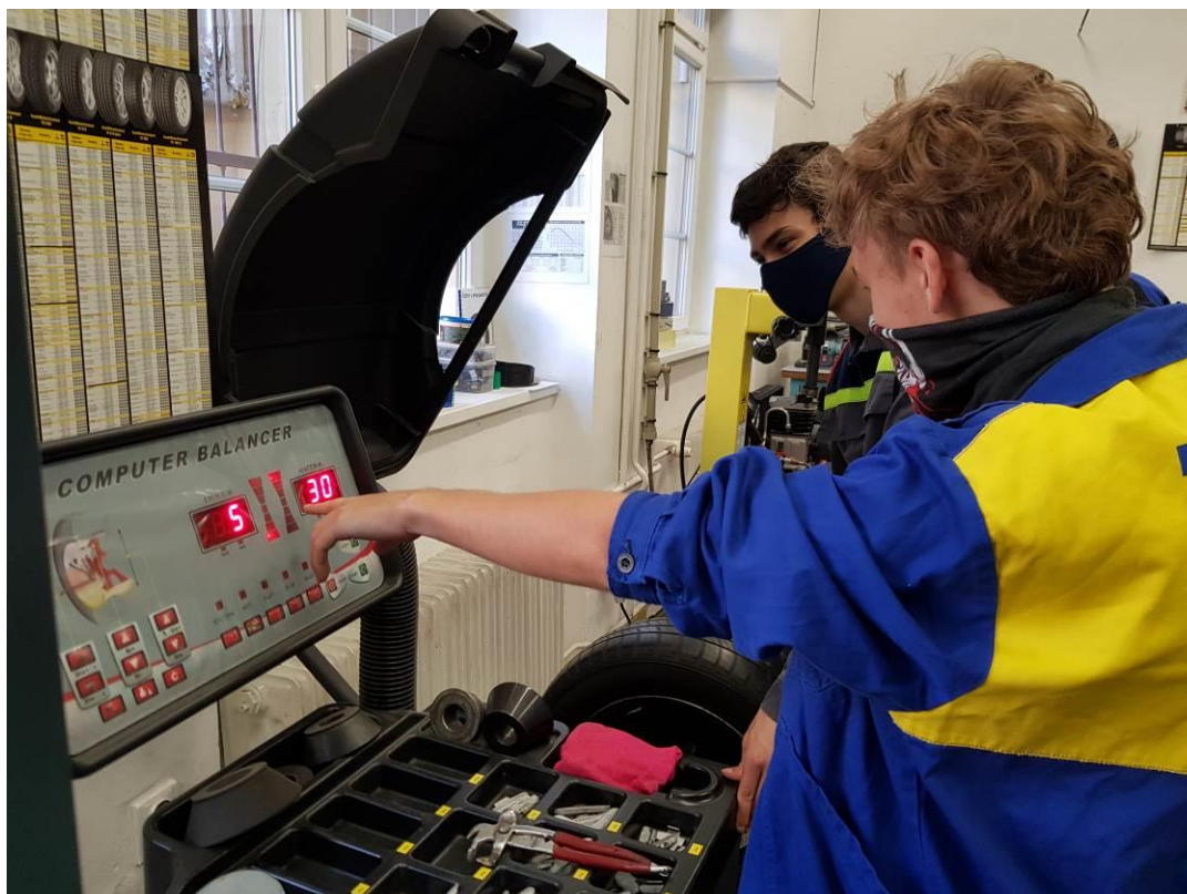
Autodílna SPŠ – vyvažování kol
